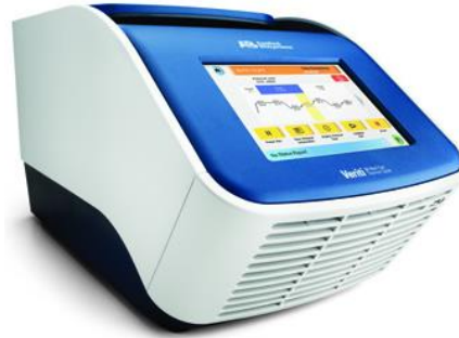
Şekil 13. Çalışmalarda kullanılan ABI Veriti™ 96 PCR cihazı
